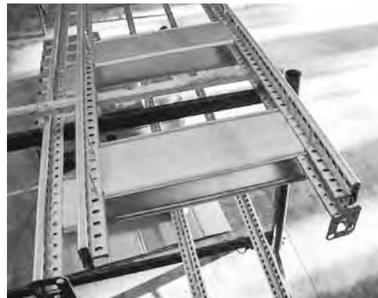
Verwendung eines Referenz-Rahmens als Montagevorlage
