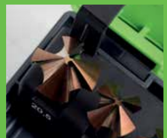
Wichtig ist dabei eine gute Schmierung des Werkzeuges
