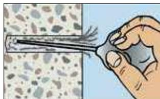
2. Bohrloch reinigen
