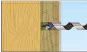
Bohrloch mit  $\varnothing$  14 mm in der Dämmung erstellen.
