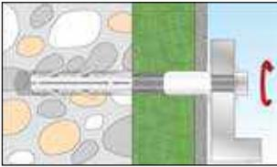
8.2. Befestigung des Anbauteils mit M6 Schraube.
