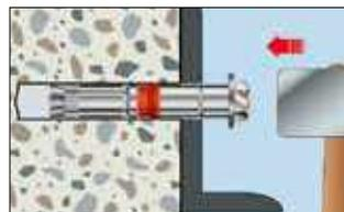
3. Anker durch zu befestigendes Bauteil stecken und einschlagen
