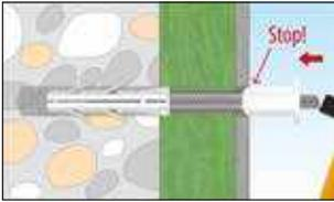
5. Gewindestange in das Bohrloch einschlagen bis das weiße Entkoppelungselement den Putz berührt.
