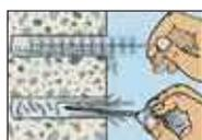
2. Bohrlöcher sorgfältig mit Stahlbürste und Ausbläser reinigen
