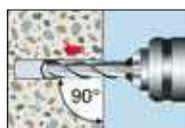
1. Löcher senkrecht zur Betonoberfläche erstellen
