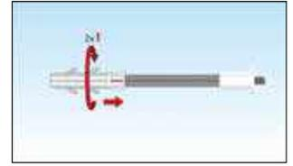
4. Dübel 14/70 mm mit max. zwei Umdrehungen auf die Gewindestange aufdrehen.
