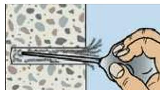
2. Bohrloch reinigen.
