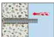
5. Ankerstange/Innengewindehülse drehend einschieben
