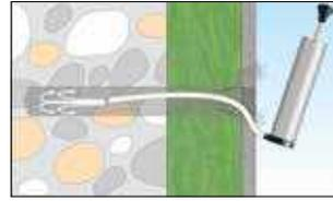
3. Bohrloch reinigen.
