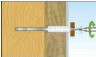
3.2 Befestigung des Anbauteils mit einer Schraube  $\varnothing$  3,0 - 4,5.
