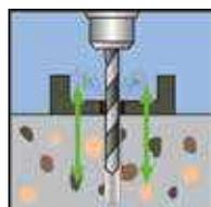
2. Bohrloch reinigen
