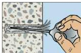
2. Bohrloch reinigen
