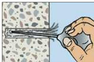
2. Bohrloch reinigen
