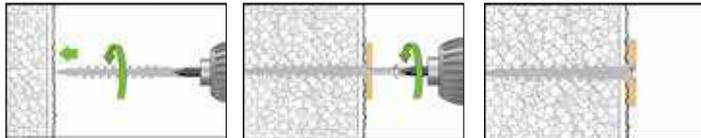
Verwendbar mit Schrauben  $\varnothing$  4,0 mm; Schraubenlänge 15-20 mm + Anbauteildicke
