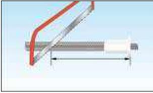
1. Gewindestange auf die benötigte Länge kürzen. Hilfestellung bietet die jedem Paket beiliegende Sägehilfe.
