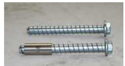
Hülse lässt sich komplett aufstecken, Schraube für Weiterverwendung nicht mehr geeignet
