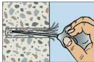
2. Bohrloch reinigen.
