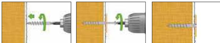
Verwendbar mit Schrauben  $\varnothing$  4,0 mm; Schraubenlänge 15-20 mm + Anbauteildicke
