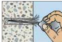
2. Bohrloch reinigen.
