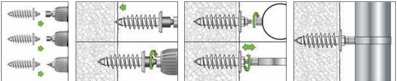
Der Isolierdübel kann mit einem Steckschlüssel-Einsatz SW 13, SW 17 oder Bit TX 25 installiert werden. Der Spezialgewindestift kann bis zu 25 mm herausgeschraubt werden. Hinweis: Sollte sich der Dübel mitdrehen, diesen mit einem Gabelschlüssel SW 17 fixieren.
