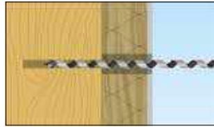
Bohrloch mit  $\varnothing$  5 mm im Holz erstellen.
