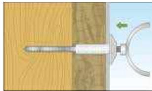
1.2 Abdeckkappe aufstecken und Rohrschelle montieren.
