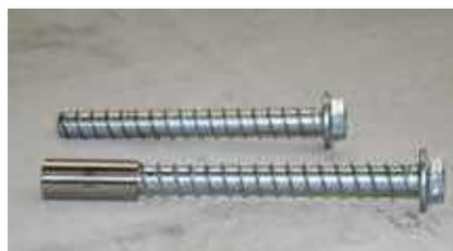
Schraube zur Weiterverwendung geeignet
