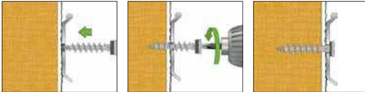
Vorsteckmontage (leichte Befestigung mittels Schraube)
