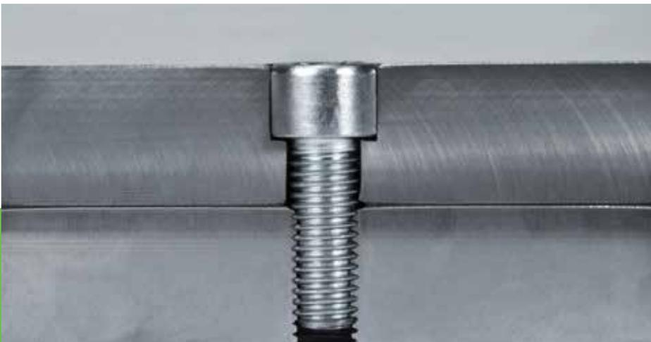
Flachsenker gibt es in zwei Ausführungen, für Durchgangsloch und Gewindekernloch. Der Unterschied liegt in den beiden Werkstücken, die mit einer Schraube verbunden werden.
