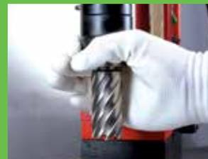
Um den Kernbohrer zu lösen, schieben Sie den Arretierungsring nach oben.
