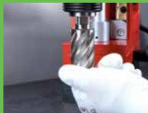
Stecken Sie den Kernbohrer in die EasyLock. Dieser arretiert mit einem lauten „Klick“. Der Arretierungsring schnappt nach unten.
