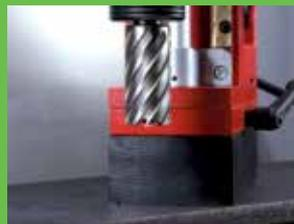
Der Kernbohrer steckt in der EasyLock. Die Maschine ist nun betriebsbereit.
