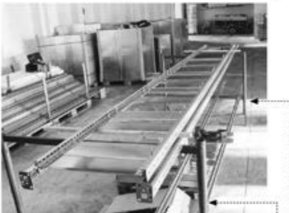
Geeignete Auflageböcke zur Montage verwenden!
