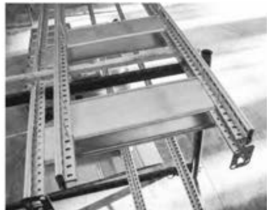
Verwendung eines Referenz-Rahmens als Montagevorlage
