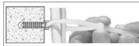
Kabelband bis 9 mm Breite durchführen und befestigen
