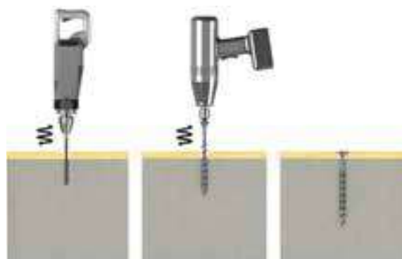
Montage mit Vorbohren
