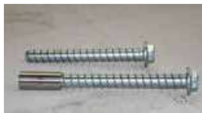
Schraube zur Weiterverwendung geeignet
