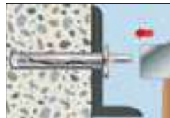
3. Deckennagel durch das Anbauteil stecken und bündig einschlagen.
