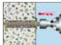
4. Ankerstange drehend schlagend eintreiben bis Markierung bündig mit der Betonoberfläche ist
