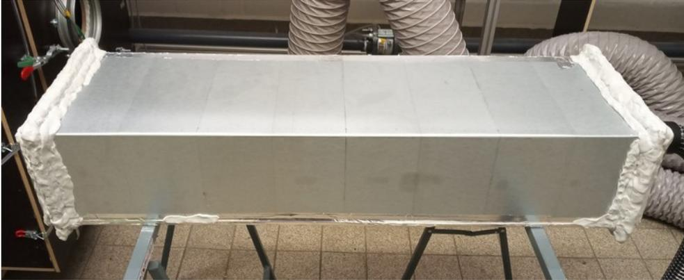
Abbildung 4.1: Luftkanal ohne Verdrängerschrauben
