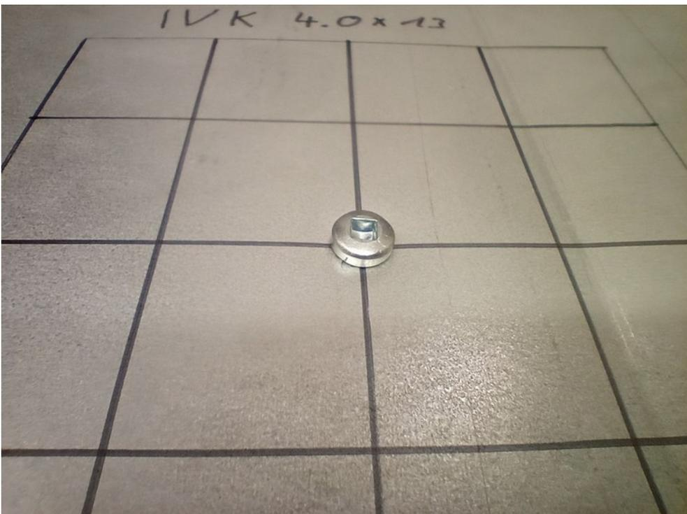
Abbildung 4.2: Luftkanal mit einer Verdrängerschraube des Typs IVK 4.0x13
