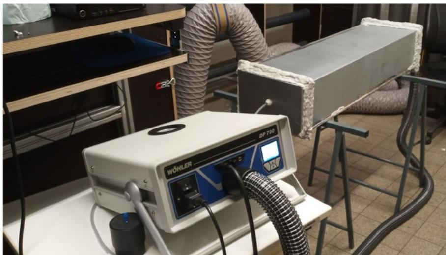
Abbildung 2.1: Prüfaufbau Luftkanal mit angeschlossenen Dichtheitsprüfgerät DP700
