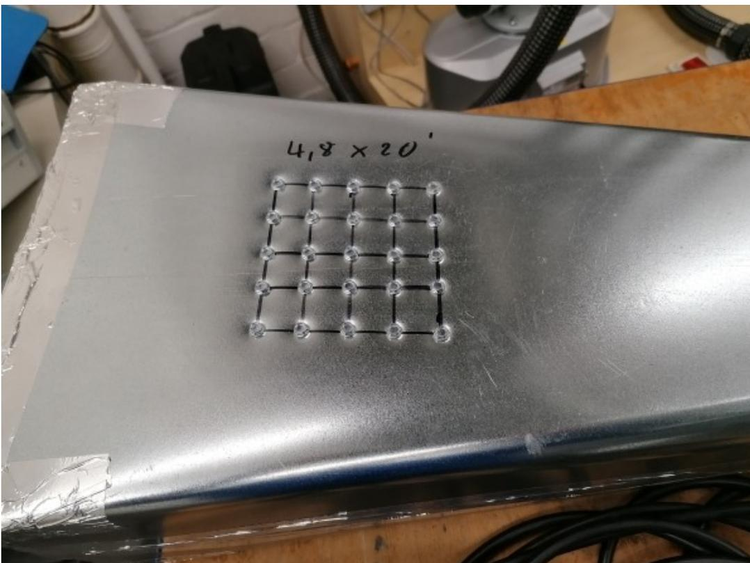
Abbildung 5.7: Luftkanal mit 25 Verdrängerschrauben Typ B 4,8x20
