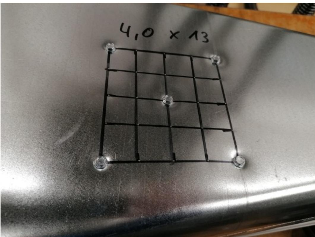
Abbildung 5.3: Luftkanal mit 5 Verdrängerschrauben Typ A 4,0x13
