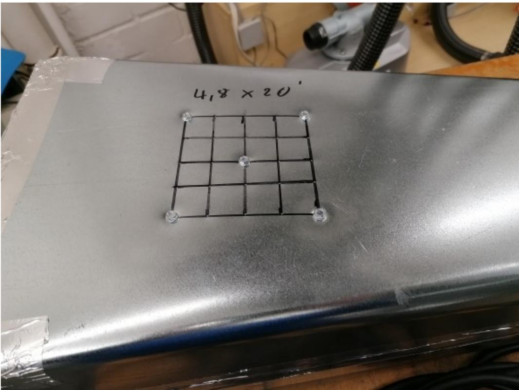
Abbildung 5.6: Luftkanal mit 5 Verdrängerschrauben Typ B 4,8x20
