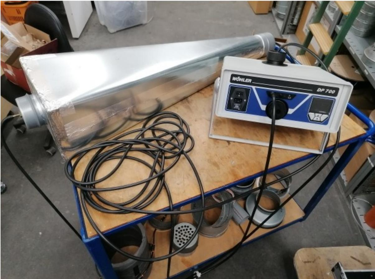
Abbildung 2.1: Prüfaufbau Luftkanal mit angeschlossenem Dichtheitsprüfgerät DP700
