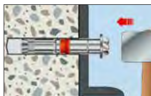
3. Anker durch zu befestigendes Bauteil stecken und einschlagen
