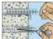
2. Bohrlöcher sorgfältig mit Stahlbürste und Ausbläser reinigen
