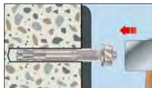
3. Bolzenanker durch zu befestigendes Bauteil stecken und einschlagen.
