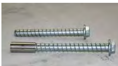
Schraube zur Weiterverwendung geeignet
