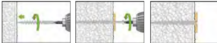
Verwendbar mit Schrauben \varnothing 4,0\text{ mm} ; Schraubenlänge 15-20 mm + Anbauteildicke
