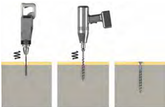
Montage mit Vorbohren
