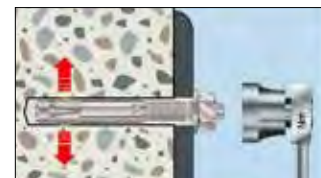
4. Vorgeschriebenes Drehmoment mit Drehmomentschlüssel aufbringen.
