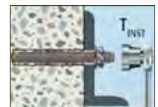
6. Bauteil befestigen, vorgeschriebenes Drehmoment aufbringen
