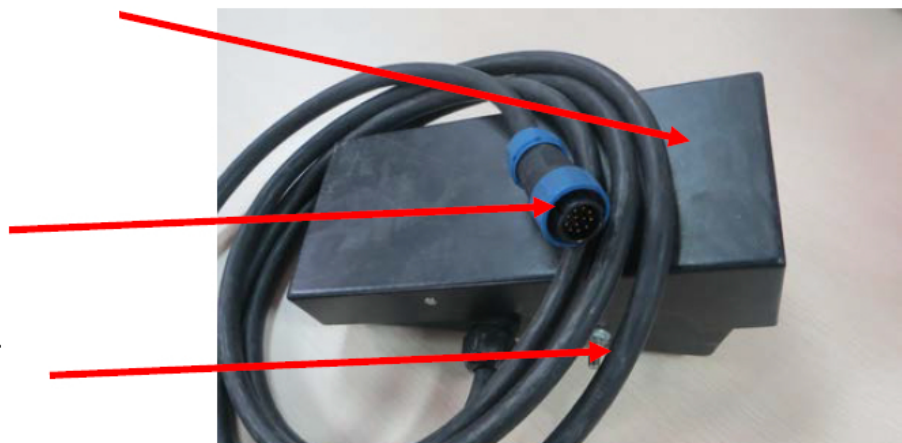
Abb. 21: Pedalsteuerung für den Schweißstrom
