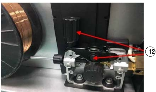
Abb. 40: Andrücken des Drahts durch die obere Anpressrolle
