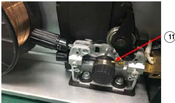
Abb. 39: Einführen des Drahts in die Zuführung
