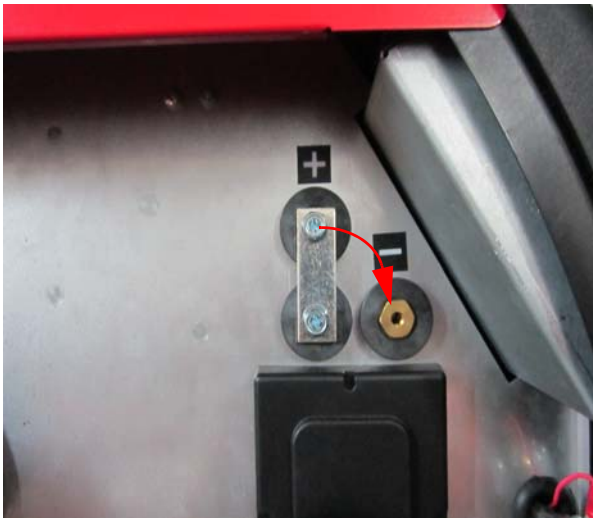
Abb. 55: Polarität des Brenners umstellen
