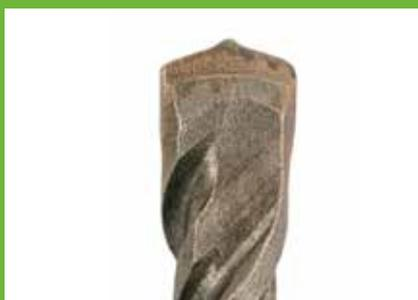
**Die aktive Zentrierspitze** bohrt punktgenau und verhindert das Verlaufen. Innovative Hartmetallplatte garantiert schnellen Bohrfortschritt. Das verzahnte Hartmetall führt den Bohrstaub direkt in die Spirale und steigert die Geschwindigkeit.
