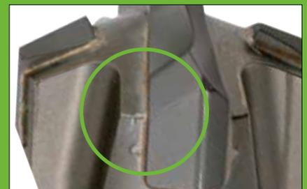
Die Verschleißmarkierung an der Kante ist das Ende der Lebensdauer erreicht und die Maßhaltigkeit nicht mehr gewährleistet.
