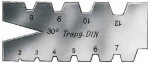
für Trapezgewinde von 2 – 12 mm Steigung nach DIN 103, Flankenwinkel 30°
