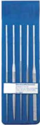
Zur Bearbeitung von gehärtetem Stahl und Hartmetall in Schnitt-, Stanz- und Presswerkzeugen, Gold, Keramik, Glas und harte Kunststoffe. Auf exakt geschmiedete Rohlinge werden Diamant-Körner galvanisch aufgebracht. Hohe Feilleistung!
