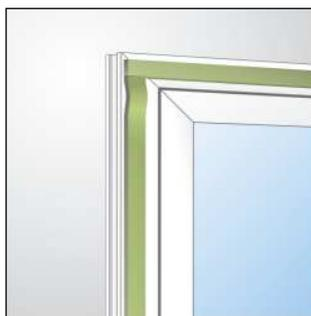
Bild 1: Bandverlegung bei der Fenstermontage
