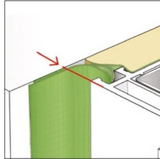
Bild 9: Positionierung der Klebraupe und der Folie
