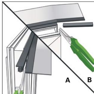
Bild 16: A) Überstände der Folie an der Keder-Knickkante einschneiden
