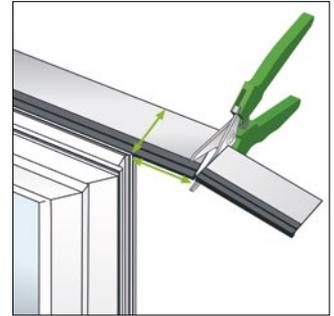
Bild 15: Folie im Eckbereich mit einem Breitenüberstand abschneiden
